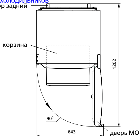
Рисунок 2 – Холодильник (вид сверху)
